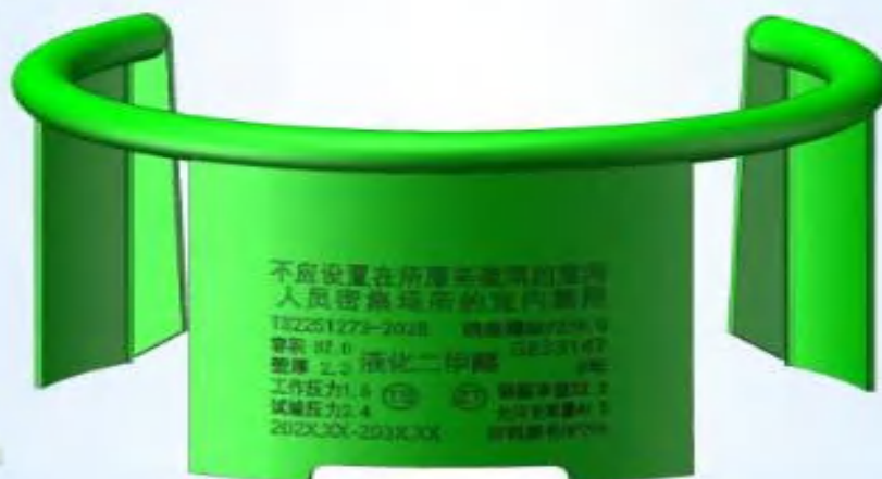
50公斤钢瓶护罩钢印标志图
